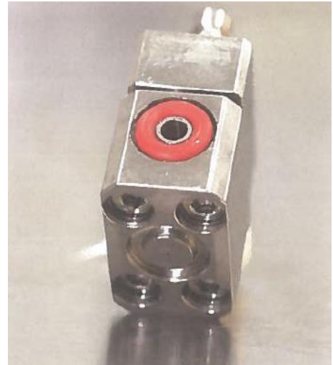
Cette pièce pas plus grosse qu'un pouce est un fondamental de la chaîne de fabrication. C'est à travers elle que les deux produits de base vont être injectés et ressortir sous forme de fibre creuse, d'un diamètre de 250 microns.
